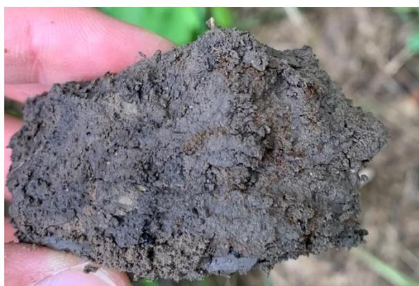
*Photo 23 : Traces rouille dans l'horizon rédoxique du sondage DUR-01*
