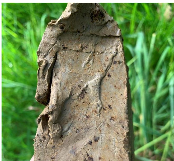
*Photo 22 : Mise en évidence de l'horizon rédoxique avec taches rouille au sondage SUR-10*
