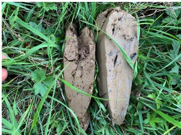
*Photo 20 : Les 2 horizons du sondage PONC-01 avec traces rouille et horizon gris réductique*
