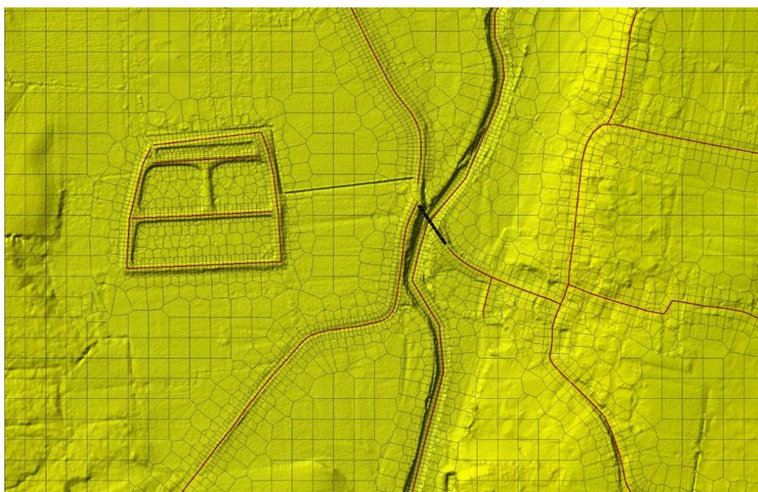
Figure 30: Aperçu du maillage irrégulier 2D du modèle hydraulique
