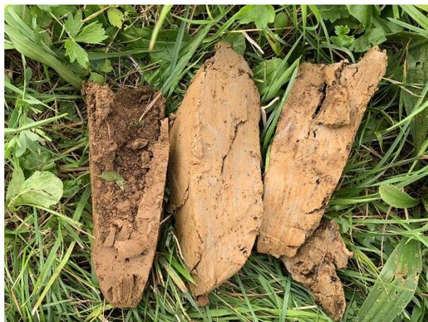
*Photo 21 : Les 3 horizons du sondages SUR-05 avec traces rouilles*
