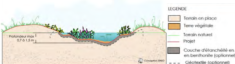
Fig. 5 : coupe de principe de la création d'une mare
