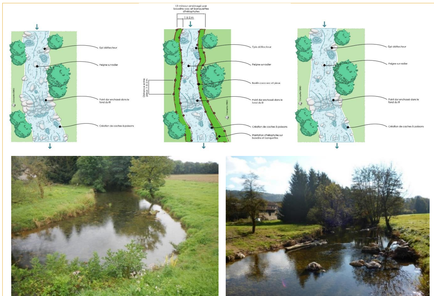
Etat initial Post travaux Exemple de mise en place d’éléments de rugosité sur l’Oignin à St Martin du Frêne
